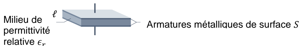
Figure 2 : Représentation schématique d'un condensateur plan
